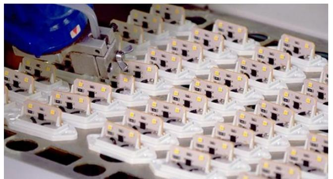
CCDアシストロボットポッティング
